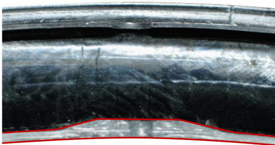
リム内部のスポークホール周りの補強は、リム全体の重量を軽減すると同時に、さらなる強度を与えます。丁寧に研磨されたスポークホールは、ホイール全体の安定性と耐久性を向上させます。
